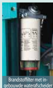
Voorfilter met ingebouwde waterafscheider
