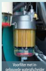
Brandstoffilter met ingebouwde waterafscheider
